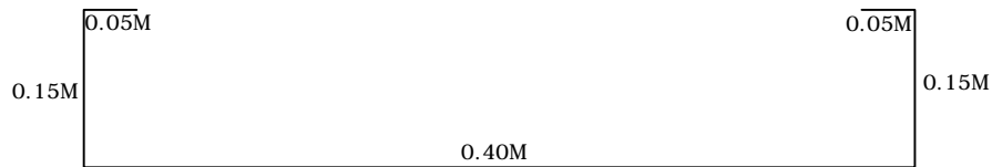
DETALLE DE CANALETA DE ELECTRICIDAD
